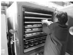
奈良文化財研究所の真空凍結乾燥機による乾燥処置
